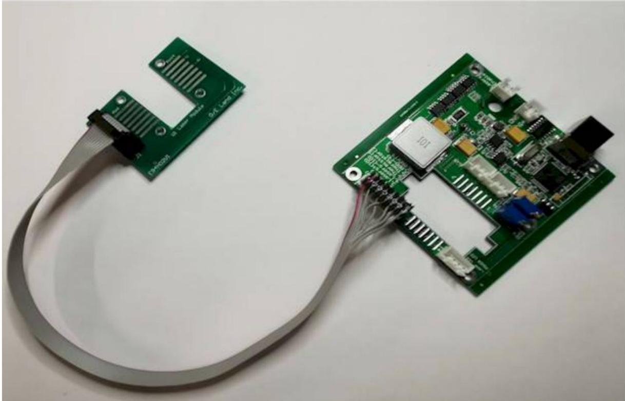
Figure 3 : OELDC-MCU-100 connecté avec un circuit imprimé de montage laser séparé
